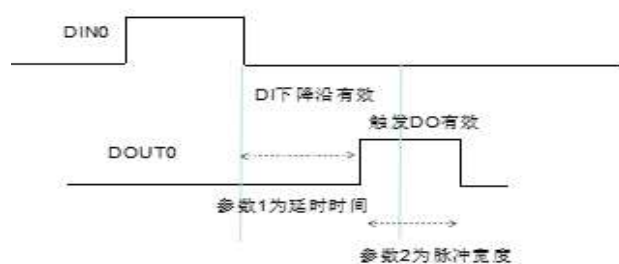
0X104：输入下降沿触发延时脉冲输出模式
